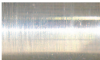
Detail povrchu kluzného ložiska motoru po testu bez výrazného poškození (při používání ŠKODA originálního olejového filtru a přečísaného motorového oleje)
