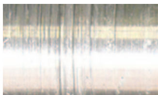
Detail povrchu kluzného ložiska motoru po testu (např. přidění vlivem nedostatečné filtrace oleje)
